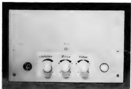
Bild 1. Ansicht des Stereo-Zusatzverstärkers mit Holz-Frontplatte und Bedienungsknöpfen
